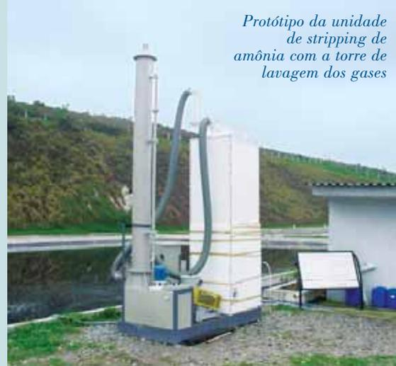
*Protótipo da unidade de stripping de amônia com a torre de lavagem dos gases*
