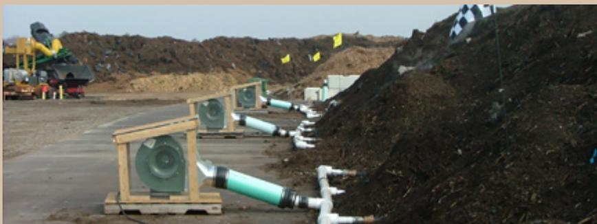
Foto 3 — Processo de compostagem utilizando sopradores de ar
