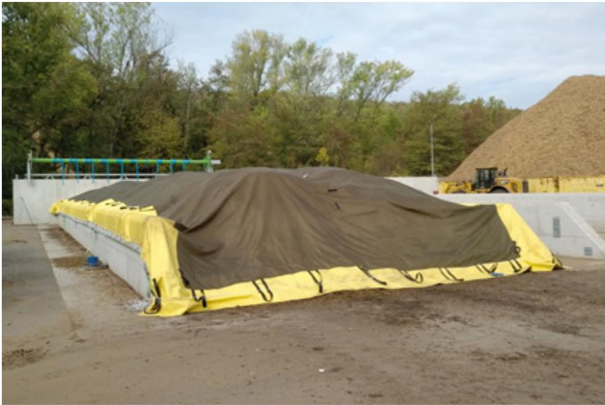
Sistema BIODEGMA, da Sutco - módulos de concreto e cobertura com membrana semipermeável
