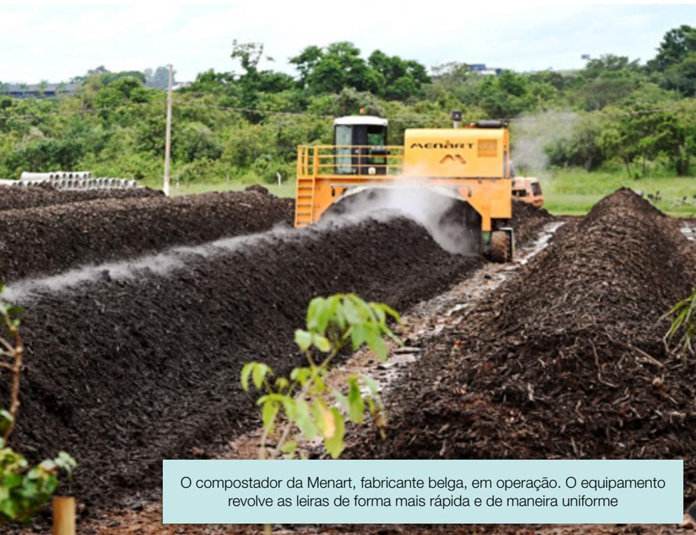
O compostador da Menart, fabricante belga, em operação. O equipamento revolve as leiras de forma mais rápida e de maneira uniforme
